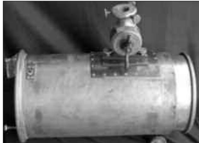
*Il Fotocauterio – vista laterale – al suo interno erano alloggiati le lenti e i filtri, la messa a fuoco era regolata tramite le manopole in basso*
